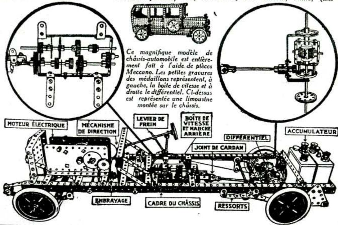
Ce magnifique modèle de châssis-automobile est entièrement fait à l'aide de pièces Meccano. Les petites gravures des médaillons représentent, à gauche, la boîte de vitesse et à droite le différentiel. Ci-dessus est représentée une limousine montée sur le châssis.
