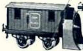
*Chass-Neige Finie en couleur. Le propulseur tournant est actionné par l'essieu avant. Prix Frs. 30-00
