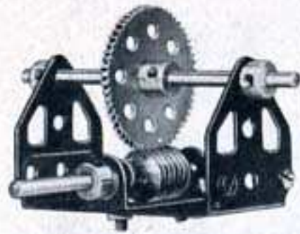
Une vis sans fin et une roue de 57 dents donnent une démultiplication très utile pour beaucoup de modèles.
