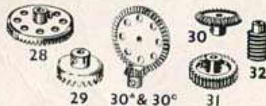
28 Roue de champ de 38 mm., 50 dents 29 » » 19 » 25 » 30 Pignon d'angle 26 dents, 22 mm. 30a » » 16 » 13 » 30b » » 48 » 32 » 30c » » 48 » 32 » Les 30a et 30c ne peuvent être utilisés qu'ensemble 31 Roue de 38 dents, 25 mm. 32 Vis sans fin
