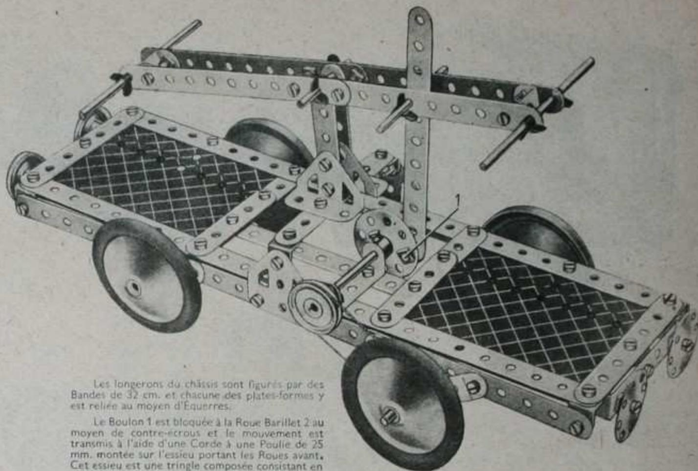
Les longerons du châssis sont figurés par des Bandes de 32 cm. et chacune des plates-formes y est reliée au moyen d'Equerres.
