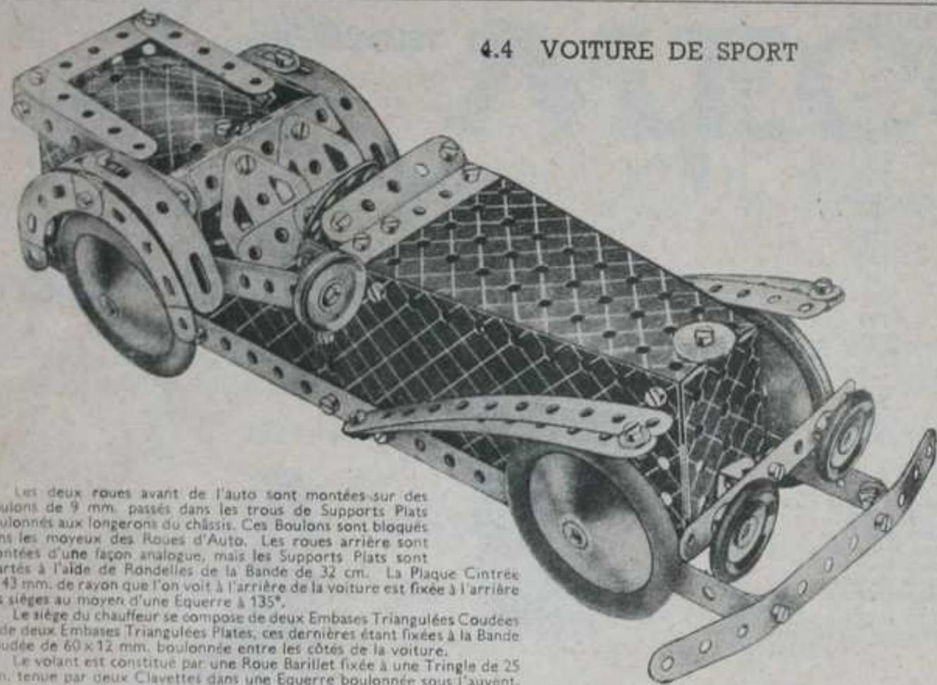
Les deux roues avant de l'auto sont montées sur des Boulons de 9 mm. passés dans les trous de Supports Plats boulonnés aux longerons du châssis. Ces Boulons sont bloqués dans les moyeux des Roues d'Auto. Les roues arrière sont montées d'une façon analogue, mais les Supports Plats sont écartés à l'aide de Rondelles de la Bande de 32 cm. La Plaque Cintrée de 43 mm. de rayon que l'on voit à l'arrière de la voiture est fixée à l'arrière des sièges au moyen d'une Équerre à 135°.
