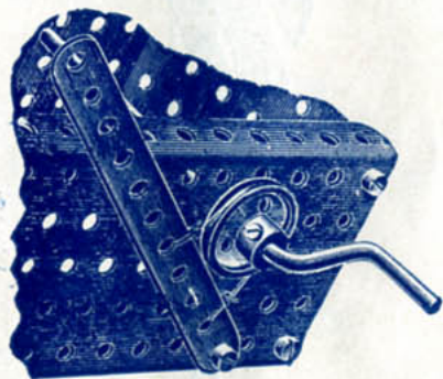
A—Mécanisme de frein applicable aux treuils et aux arbres en général.
