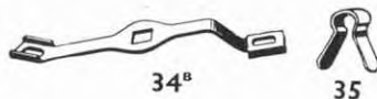
34 Clef 34b » porte-écrou 35 Clavette 36 Tournevis 36a » manche bois 36c Tige effilée 37 Ecrou et boulon 5 mm. 37a Ecrou 37b Boulon 5 mm.
