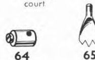
64 Raccord taraudé 65 Fourchette de centrage 69 Vis d'arrêt 69a » sans tête, long. 4 mm. 69b » » 5,5 » 69c » » 2 »
