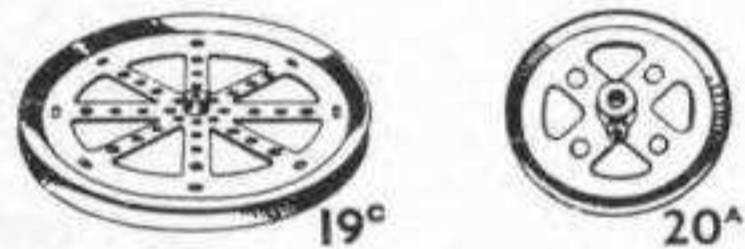
19b Poulie, diam. 75 mm., à moyeu 19c » » 15 cm., » 20a » » 5 » »
