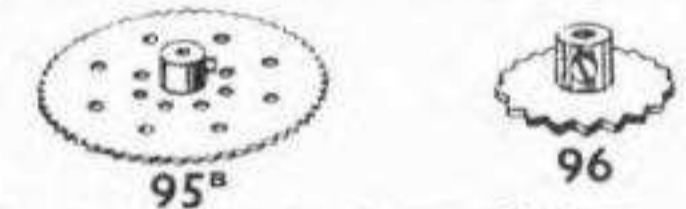
95 Roue de chaîne de 5 cm., 36 dents 95a » » 38 mm., 28 » 95b » » 75 » 56 » 96 » » 25 » 18 » 96a » » 19 » 14 »
