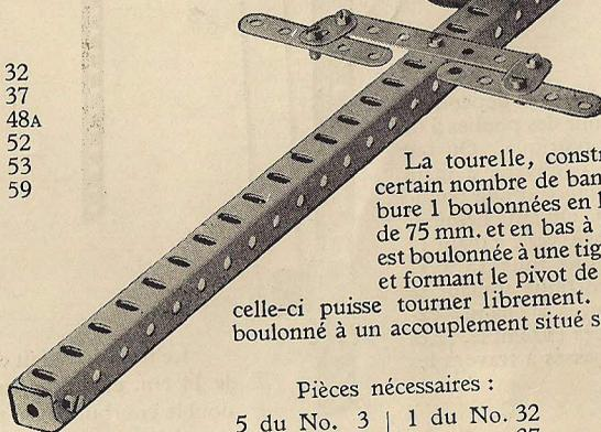
La tourelle, construite à l'aide d'un certain nombre de bandes à double courbure 1 boulonnées en haut à une poulie 2 de 75 mm. et en bas à un Plateau Central est boulonnée à une tige montant au centre et formant le pivot de la tourelle pour que celle-ci puisse tourner librement. Le canon 4 est boulonné à un accouplement situé sur cette tige-pivot.
