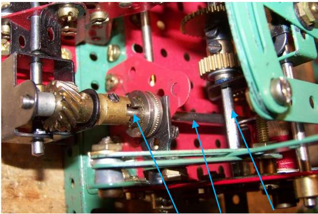
Abb. 7: Detailansicht Wellen 5a und 5b, Welle 6
