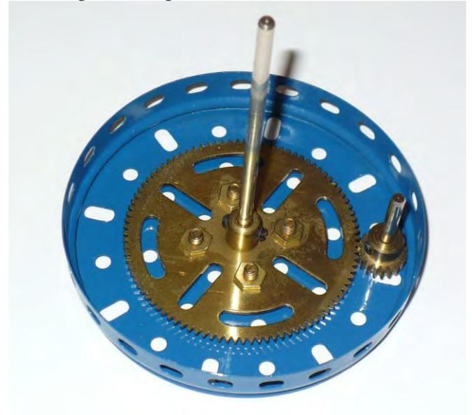
*Antrieb der Räder über eine 19/95-Übersetzung*
