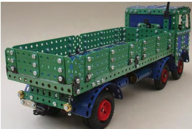
Zuletzt wurden mit einer Federwaage die Gewichtskräfte gemessen, die auf Vorderachsen und Hinterachse lasten, und daraus die Daten der erforderlichen Federn ermittelt. Das hatte ich bereits an anderen Modellen praktiziert und auch hierbei zeigte sich ein weiterer Nachteil kleiner und leichter Modelle. Im vorderen Bereich wird das Gewicht auf insgesamt 8 Druckfedern verteilt.
