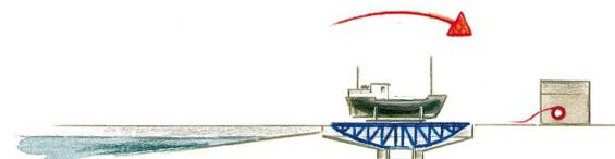
**Phase 4** - Giration du pont vers sa voie de garage et alignement sur la voie concernée. Les voies ont des capacités différentes de 250 à 1300 tonnes.
