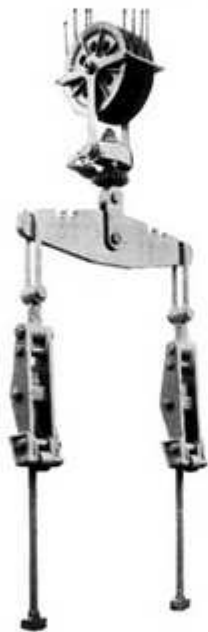
Engrenage Fidler, prêt à être attaché à un bloc de ciment.
