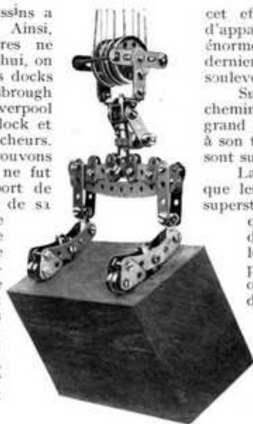
(Dessus) Bloc de ciment maintenu en position par un engrenage Fidler. (Dessous) Modèle Meccano de l'engrenage Fidler reproduisant tous les mouvements de l'original.
