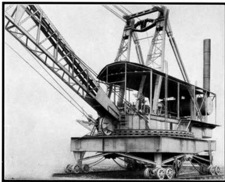
(Dessus) Comment l'Excavateur trace son chemin dans le sol. (Dessous) Vue de l'immense chariot sur lequel roule l'Excavateur.
