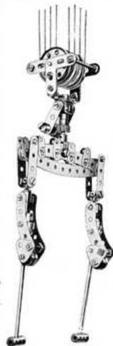
Modèle Meccano de l'engrenage Fidler, à comparer avec l'originale à gauche de la page.
