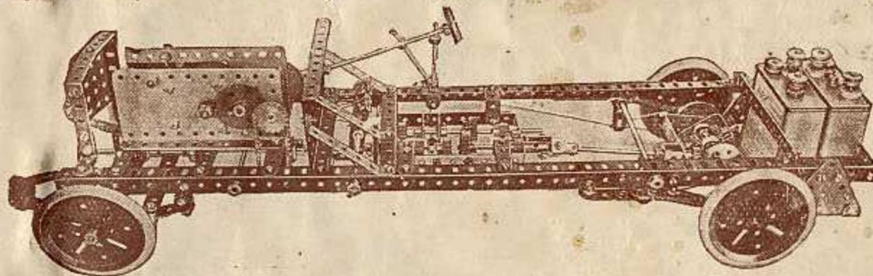
Au châssis automobile Meccano rien ne manque, ni la boîte des vitesses, ni le différentiel. Une feuille spéciale donne les instructions complètes pour le montage.
