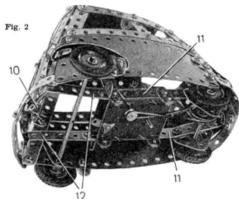
des (11). Une poulie de 25 mm montée au milieu de l'essieu est reliée par une courroie à la poulie du moteur. L'essieu avant est une tringle de 13 cm qui passe dans l'angle des plaques flexibles triangulaires (6) et des plaques flexibles de 14 x 6 cm. Les roues sont des poulies de 25 mm équipées de pneus.
