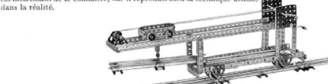
Il s'agit, en fait, d'un wagon qui avance sur les rails au fur et à mesure de leur mise en place ; grâce à un portique en porte-à-faux, un chariot grue soulève les rails dont est chargé le wagon et les place à l'extrémité de la voie en construction. Les illustrations de cette page montrent les deux temps de l'opération.
