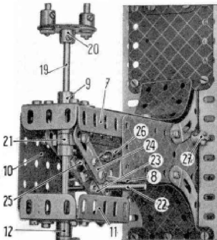
boulonnés dans deux trous opposés de la roue barillet (20) maintiennent deux tringles de 5 cm., qui peuvent coulisser dans les trous correspondants de la roue barillet (17).
