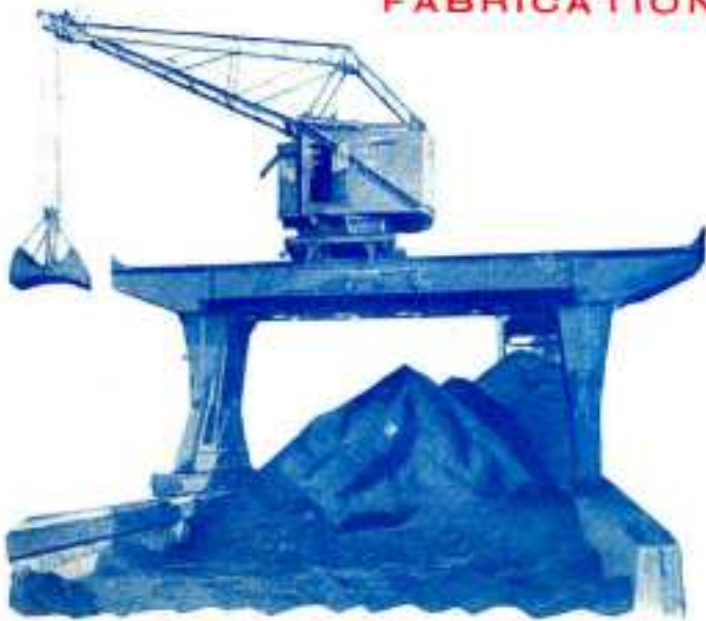
Crue réaliste électrique à benne piochante sur pont roulant (puissance 3.500 kgs), construite par les Ets Caillard et C o , Le Havre.
