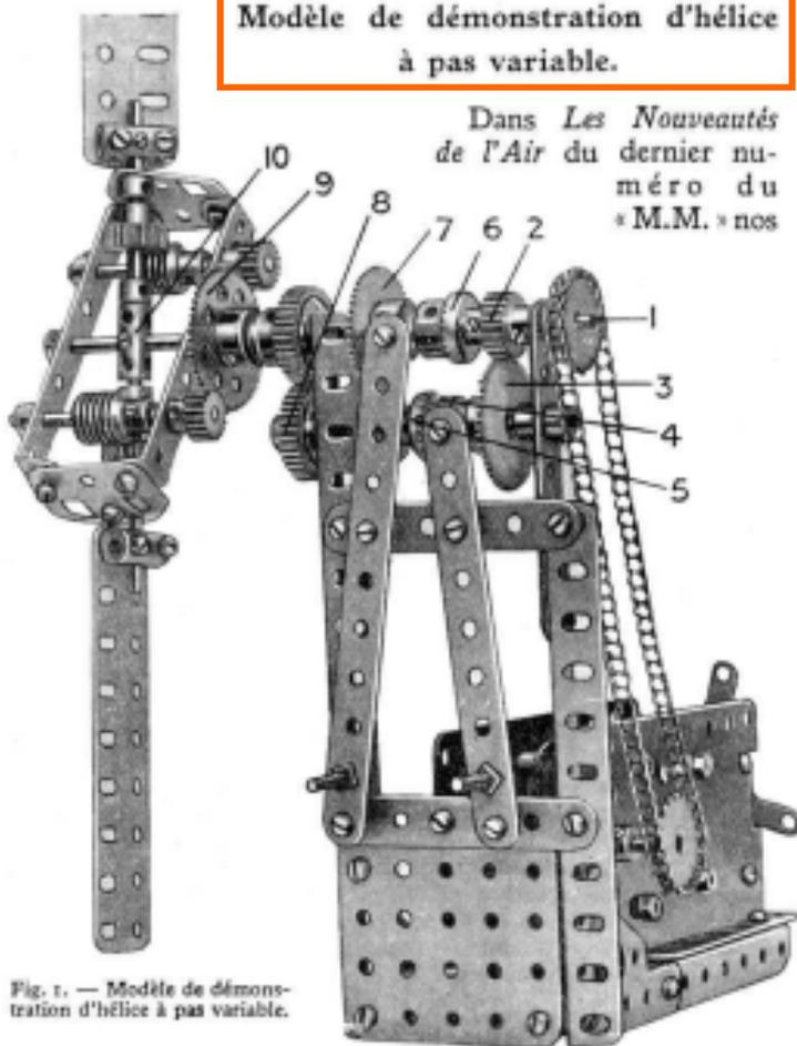
Fig. 1. — Modèle de démonstration d'hélice à pas variable.
