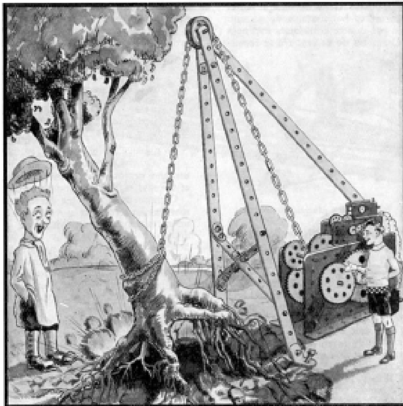
Cette gravure donne une idée des possibilités théoriques des fortes démultiplications de l'ordre de celle dont il est question dans l'article. Il est évident, toutefois, que ce qui est gagné en puissance se compense par une perte en vitesse, et pour soulever l'arbre de plusieurs centimètres, il faudrait faire marcher le moteur pendant des années entières.
