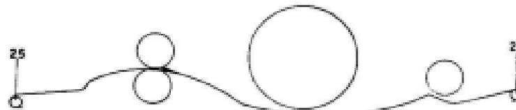
Fig. 4. Ce croquis représentant le profil de l'une des bandes-guides est exécuté exactement à la moitié de la grandeur naturelle de cette pièce.
