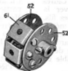
Fig. 3. Came actionnant les chasse-navette.
