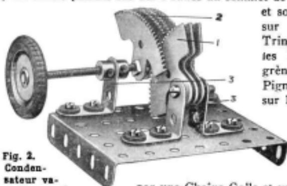
Fig. 2. Condensateur variable en pièces Meccano.
