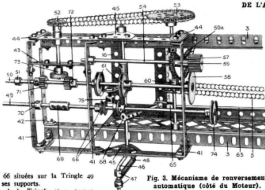
Fig. 3. Mécanisme de renversement automatique (côté du Moteur).
