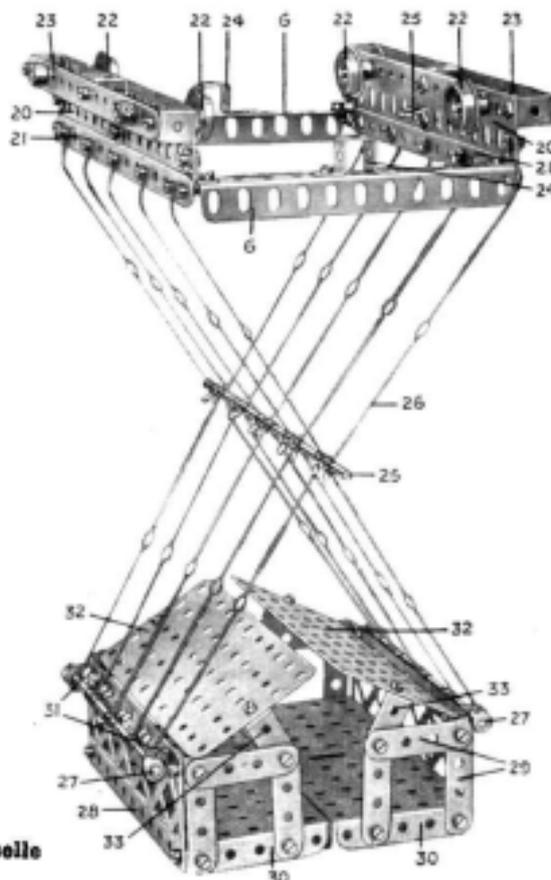
Fig. 5. Le trolley avec la nacelle suspendue.
