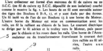
Afin de pouvoir mettre en marche et arrêter la loco à volonté, on introduira dans le circuit un interrupteur qu'on placera soit entre l'accumulateur d'un côté et le fil aérien, soit les rails, de l'au-
