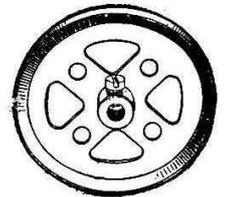
20a Poulie de 50 mm avec vis de serrage. pièce 1 60
