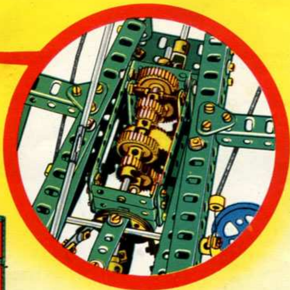
Boîte à 3 vitesses et marche arrière montée sur le splendide châssis d'auto illustré ci-contre.
